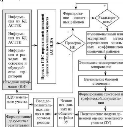
Рисунок 4 – Общая логическая схема предлагаемой технологии
