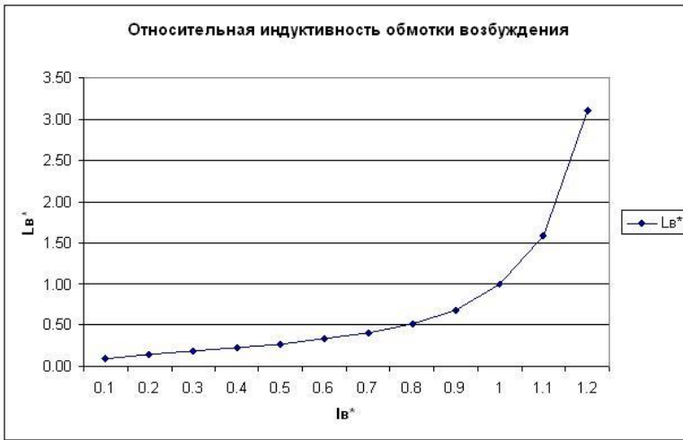
Рисунок 2 График изменения относительной индуктивности обмотки возбуждения
